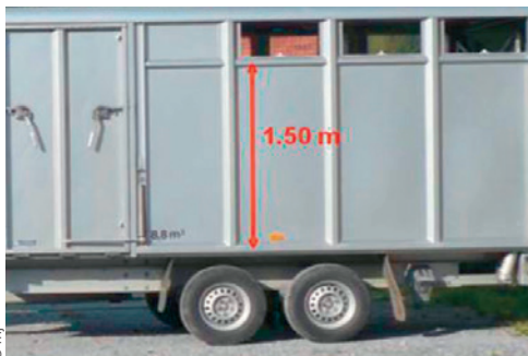
Anhänger für Grossvieh; Nicht perforierte Wand
