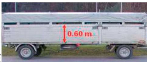
Anhänger für Kleinvieh; Nicht perforierte Wand
